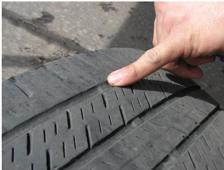
A bordázat közé beépített jelölő dudor jelzi, ha a futófelület kopása 1,6 mm alá csökken.
